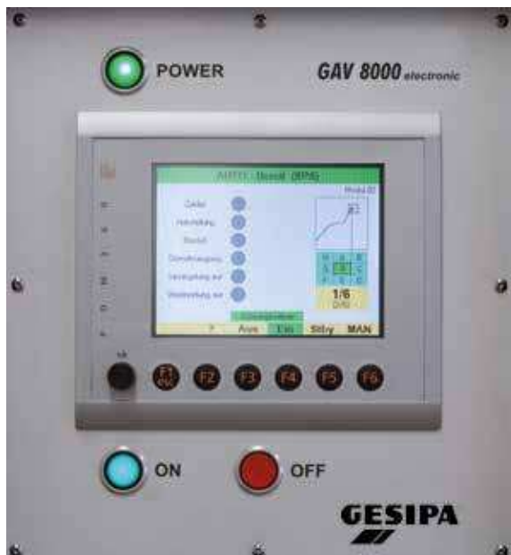
Displej zařízení GAV 8000 electronic s vyobrazenou nýto- vací křivkou - částí kontroly nýtovacího procesu
