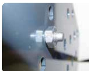
Matice, zatlačena mírnou silou na závitový trn, se automaticky zakrouží.
